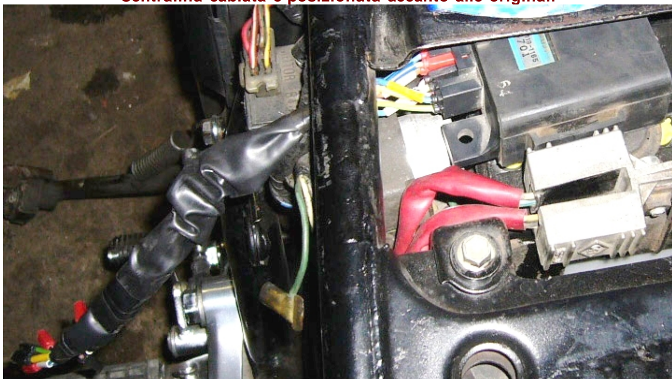
Centralina cablata e posizionata accanto alle originali
